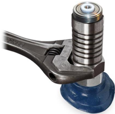
Monter elektronisk del i standerrør og til spænd med mekanisk del med moment afhængig af gevindtype (80-150 Nm).
