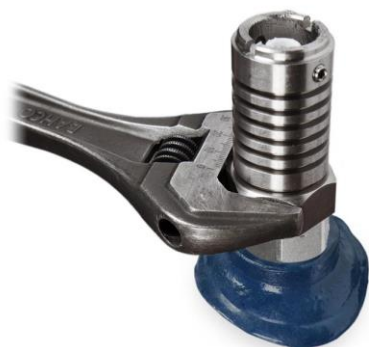
Instale el sensor en el recipiente y apriételo según el tamaño y el tipo de rosca (80-150 Nm).
