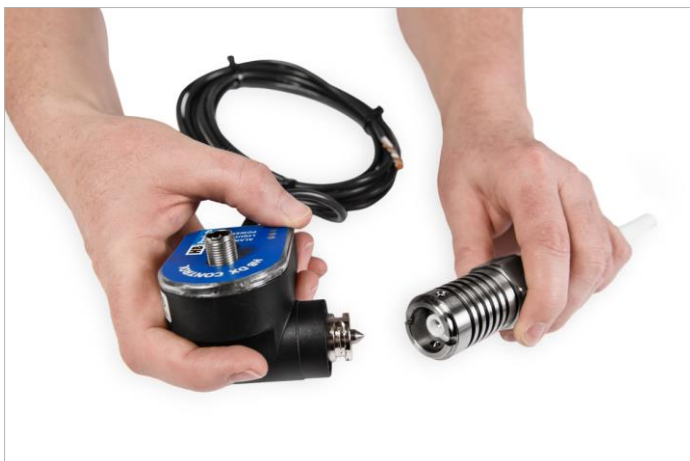
Separe la parte electrónica de la mecánica.
